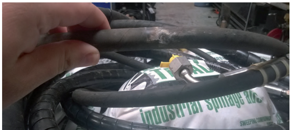
Afb. 8. Voorbeeld van een slangassemblage die is blootgesteld aan beschadiging van buitenaf
