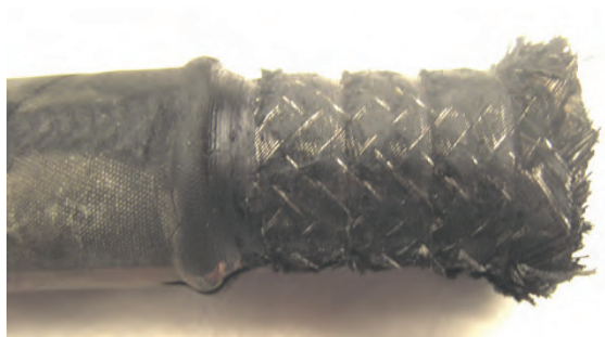
Afb. 6. Een voorbeeld van slecht vakmanschap bij het voorbereiden van slangassemblages
