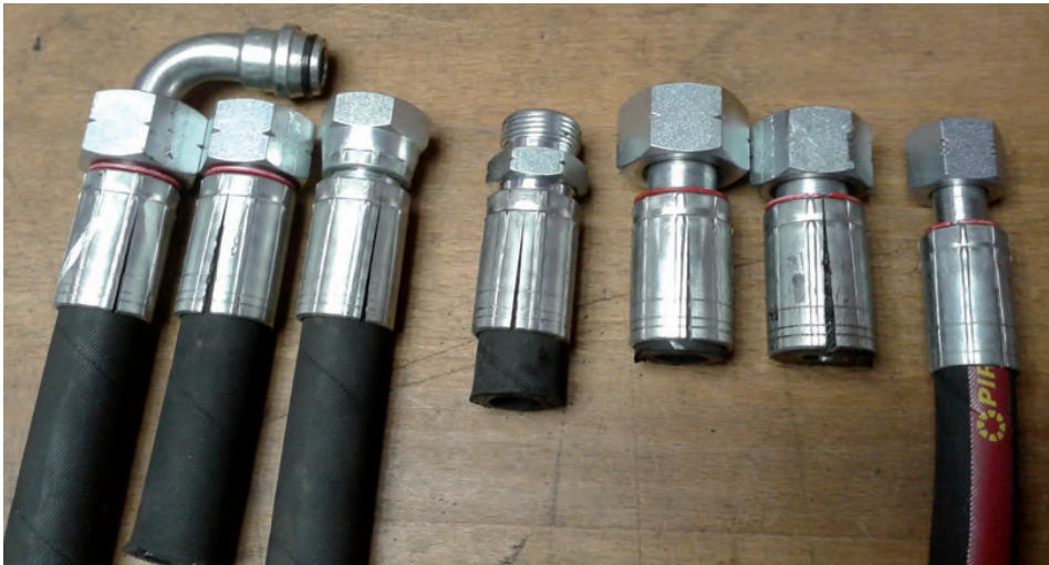
Afb. 9. Voorbeelden van slangassemblages die zijn uitgevoerd met onjuist gereedschap
